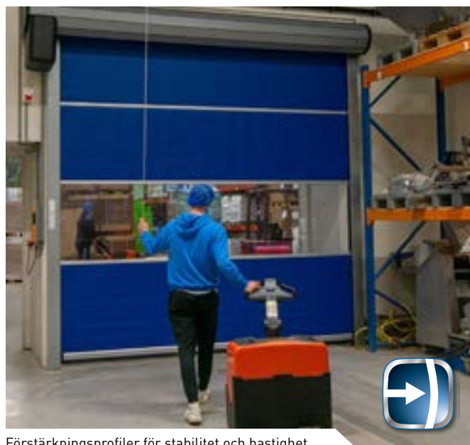
Förstärkningsprofiler för stabilitet och hastighet
