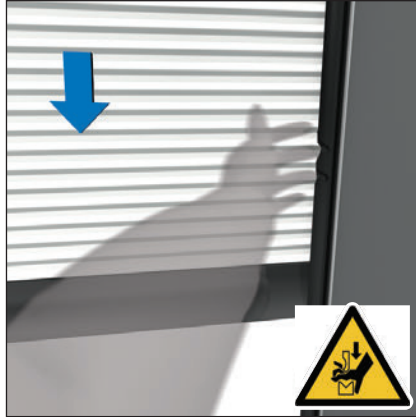
2. Varning! Risk för klämskada!
