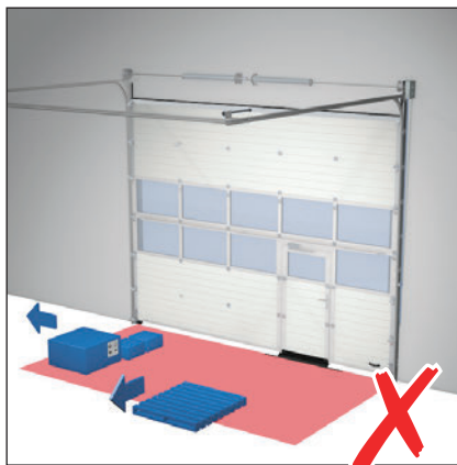
8. Förvara inte något material i området vid porten.
